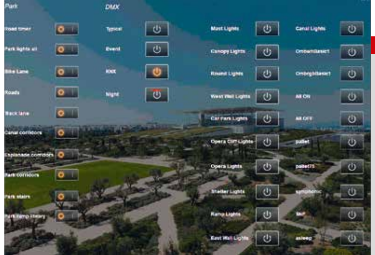
Bild 4. Statusanzeigen für Außenbeleuchtung (z. B. Straße, Park, Parkplatz), Beleuchtungssituationen im Objekt, der Medien und Darstellung der eingebundenen Gewerke
